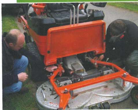
Les interventions sur le plateau de coupe sont simples, on aperçoit ici la goulotte d'éjection centrale métallique qui s'engage dans le carter de la tondeuse.
