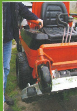
Le relevage du plateau de coupe est hydraulique, après avoir dételé le carter, il se met en position de service.
